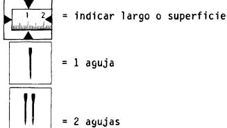
2.2 Para los ribeteadores hay que indicar el ancho de la cinta, para las garniciones de 2 agujas, la distancia entre agujas, y para los elementos de corte, la distancia de corte.
