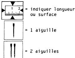
2.2 Dans le cas d'appareil bordeur indiquer la largeur de ruban, dans le cas de garniture à deux aiguilles, la distance de coutures, dans le cas de garniture de coupe, la distance de coupe.
